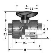
Mit gesicherten Überwurfmuttern und metrischen Schweißstutzen. Dichtungen aus PTFE/EPDM oder PTFE/FKM. Maße in mm.
