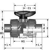
Mit gesicherten Überwurfmuttern und Gewindemuffen mit Gewindeanschluss nach ISO 228-1. Dichtungen aus PTFE/EPDM oder PTFE/FKM. Maße in mm.
