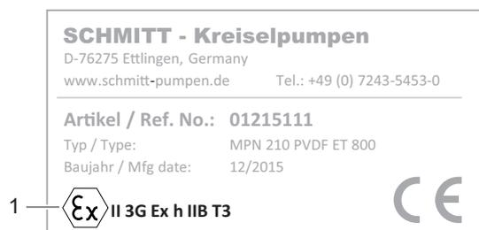
Abb. 2 Typenschild ATEX (Beispiel)
